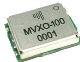
MVХО-100 — кварцевый ГУН с номинальной выходной частотой 100 МГц. Генератор предназначен для использования в измерительной, связанной и радиолокационной технике в качестве источника с высокой кратковременной фазовой стабильностью, достигаемой благодаря применению высокочастотных кварцевых резонаторов. Генераторы с резонаторами АТ-среза отличаются малыми габаритами и энергопотреблением при умеренно высокой фазовой стабильности выходного сигнала и высокой температурной стабильности частоты.
